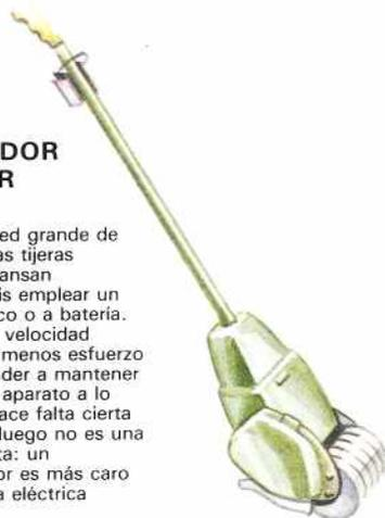
Si tenéis un césped grande de bordes firmes y las tijeras bordeadoras os cansan demasiado, podéis emplear un bordeador eléctrico o a batería. Trabajaréis a una velocidad similar, pero con menos esfuerzo físico. Para aprender a mantener el rumbo de este aparato a lo largo del borde hace falta cierta práctica y desde luego no es una herramienta barata: un bordeador a motor es más caro que una segadora eléctrica pequeña.
