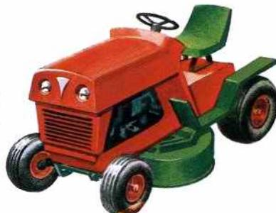
Es una verdadera segadora conducida, con un asiento incorporado. Entre las ruedas lleva una o varias cuchillas rotatorias. Algunos modelos cuentan con un depósito para los recortes de hierba. Es ideal para grandes extensiones de hierba gruesa. Anchura del corte 60-125 cm.
